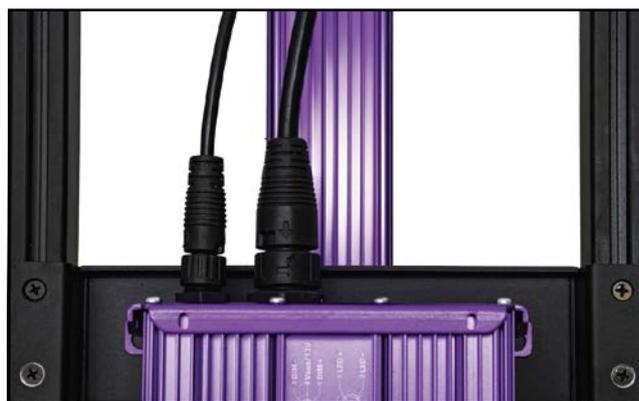
Stellen Sie sicher, dass die selbstverriegelnden Stecker des Treibers und des Dimmers korrekt auf die entsprechenden Buchsen des Treibers ausgerichtet sind und drücken Sie sie zusammen, bis sie mit einem Klick einrasten. Zum Trennen der Verbindung drehen Sie den Stecker gegen den Uhrzeigersinn, um ihn zu entriegeln und ziehen Sie ihn von der Buchse ab.
